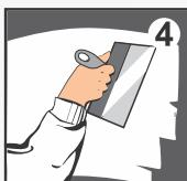
Нанесите шпатлевку на поверхность металлическим шпателем или кельмой слоем от 0,1 до 2 мм. Время высыхания между слоями 2 часа. Шлифование финишного слоя рекомендуется производить через 2-4 часа после нанесения. Время полного высыхания 24 часа. По окончании работы инструменты промойте водой. Дальнейшие отделочные работы можно проводить после полного высыхания шпатлевки.
